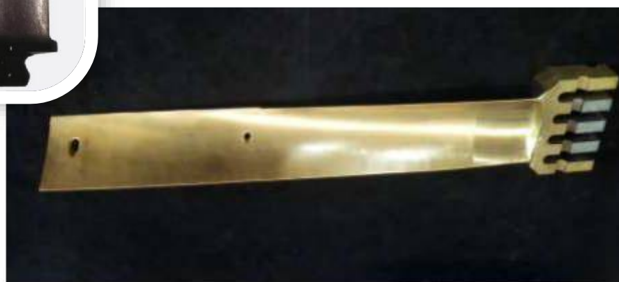
نمونه پره توربین بخار با پوشش اعمال شده با روش PVD (به رنگ طلایی)
